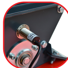
CZUJNIK KONTROLI POZIOMU NASION FÜLLSTANDSSENSOR FÜR SAATGUT SEED LEVEL CONTROL SENSOR
