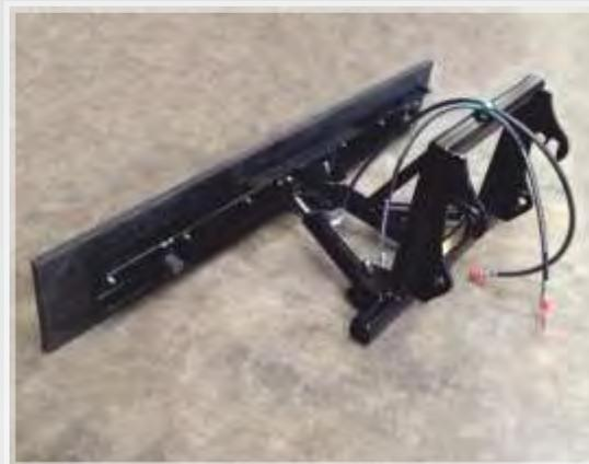
Gerade, hydraulische Schwenkeinrichtung
